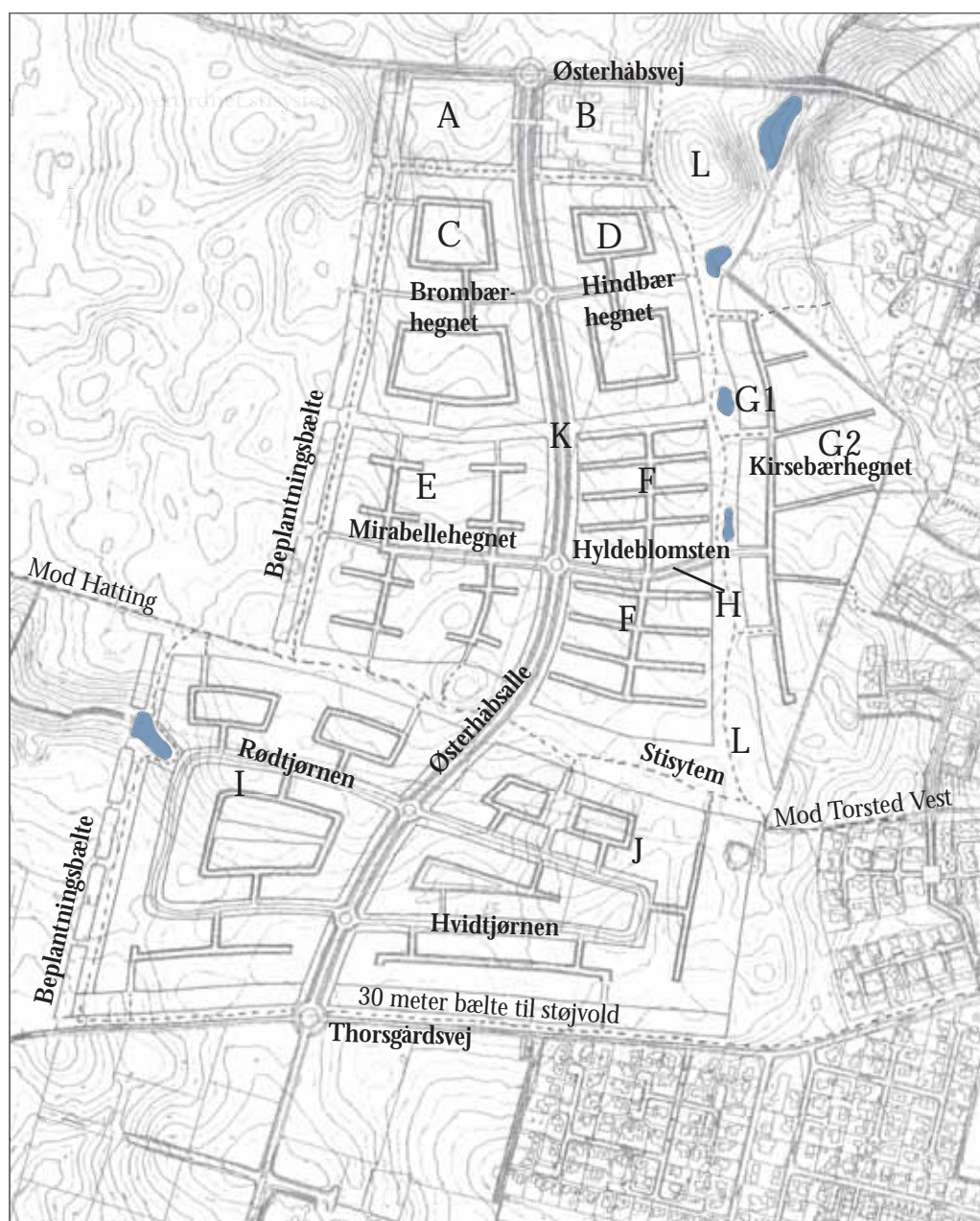
Illustrationplan for det nye boligområde, 1:10000. Den stiplede linie viser det overordnede stisystem. De blå markerede felter viser i princippet placeringen af regnvandsbassiner.
